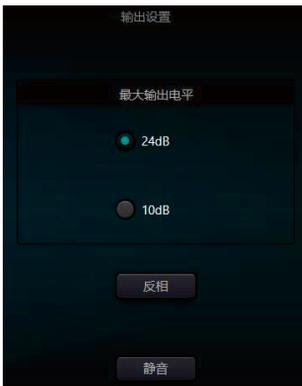
**最大输出电平：**硬件最大输出电平，24dBu、10dBu可切换。
