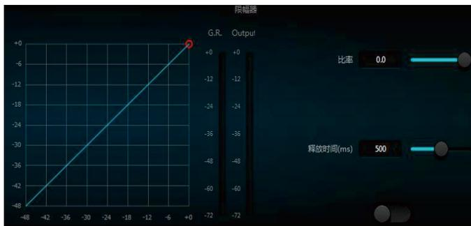
也叫限制器，它只有一个关键任务：无论在什么情况下，确保信号不会超过门限电平。通过调整压缩器的控制参数，可以让它的工作方式与限制器非常相似。限制器工作原理的核心，是它真正关系门限电平以下的信号内容，以及在信号发生过冲之前增益衰减量是如何开始产生的。限制期通过两个处理阶段来完成相应的处理，在第一个阶段只是进行比较轻微的限制，但是并不会处理过冲信号，然后在第二阶段，如果信号产生了过冲，它们就会以非常剧烈的方式进行衰减。
