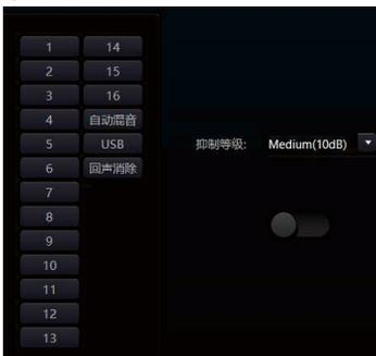
**抑制等级：**共有Mild(6dB)、Medium(10dB)、Aggressive(15dB)三种类型可选。dB的含义是抑制噪声降低多少dB，值越大，对语音的伤害也越大，这是无法避免的
