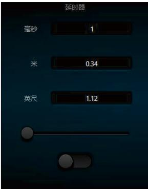
**激活按钮：**在模块中激活指定的延时模块，将其插入到音频信号路径中，对信号增加固定的延时时间。
